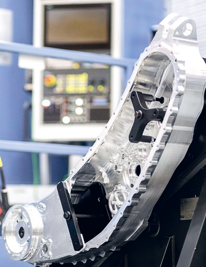
Carter de transmission de puissance du moteur LEAP-1B , usiné sur le nouveau centre « 5 axes » suivant le procédé du taillé masse.
