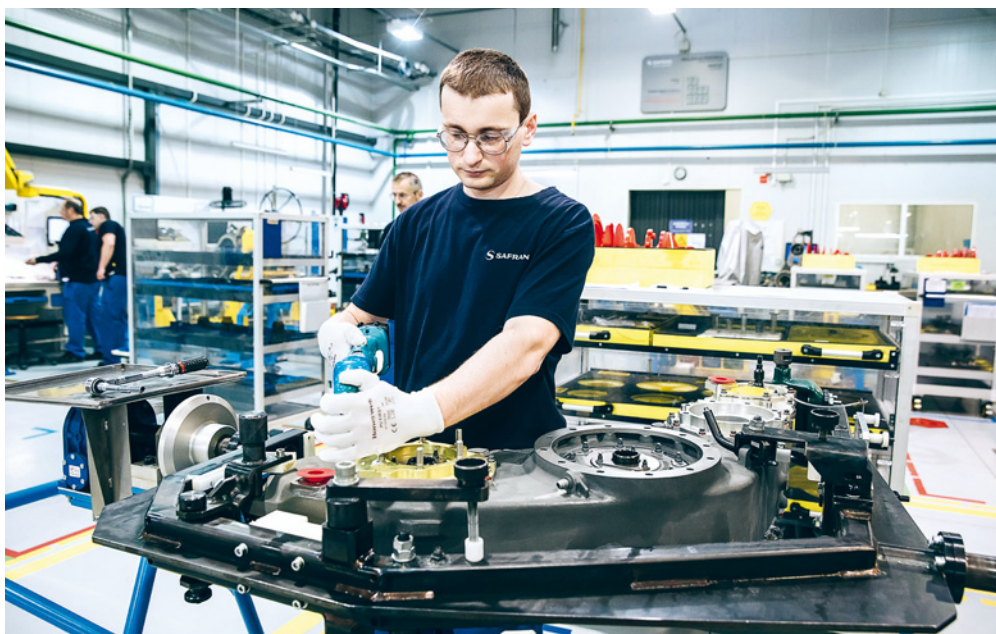
Mateusz FITOŁ, Safran Transmission Systems Poland, sur la ligne de montage du boîtier d'accessoires du LEAP.
