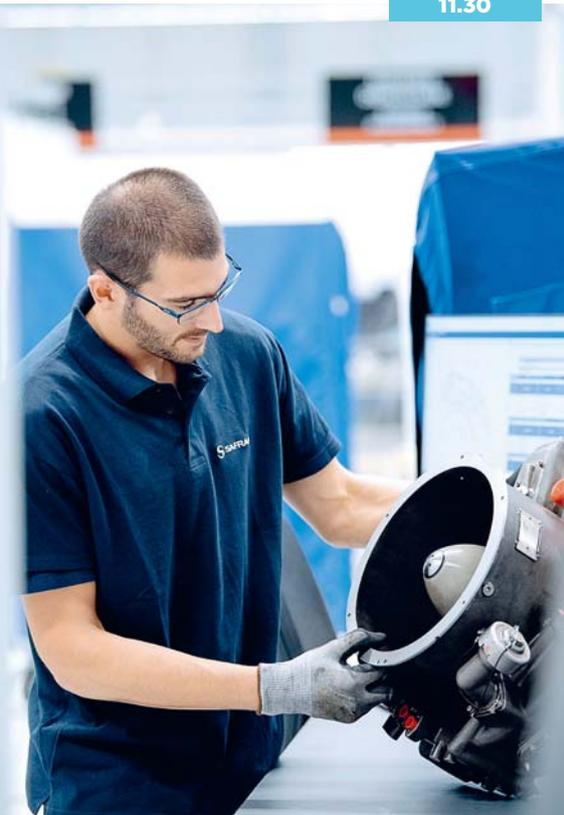
Los empleados pueden utilizar otra técnica para la identificación de daños: el control visual.
