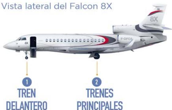
Safran Landing Systems provee los trenes de aterrizaje de los Falcon desde el primer avión de la familia, lanzado por Dassault en 1964, hasta el más reciente Falcon 8X. Todos los Falcon poseen trenes de aterrizaje triciclos retráctiles hidráulicamente: el tren principal se eleva hacia el interior y el tren delantero hacia adelante.
