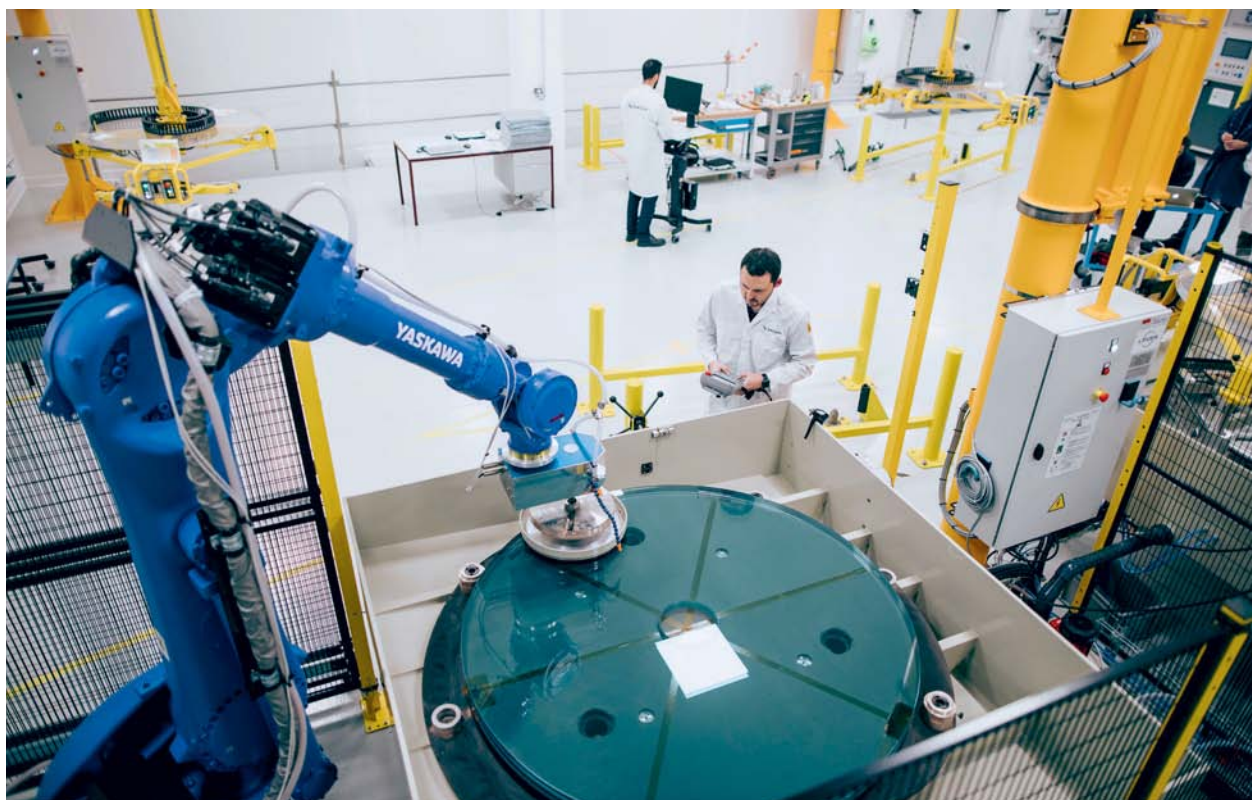
Lancement d'une opération de polissage avec des moyens de production robotisés pour une qualité nanométrique.
