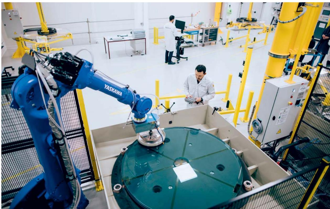
**Inicio de una operación de pulido** con medios de producción robotizados para lograr calidad nanométrica.
