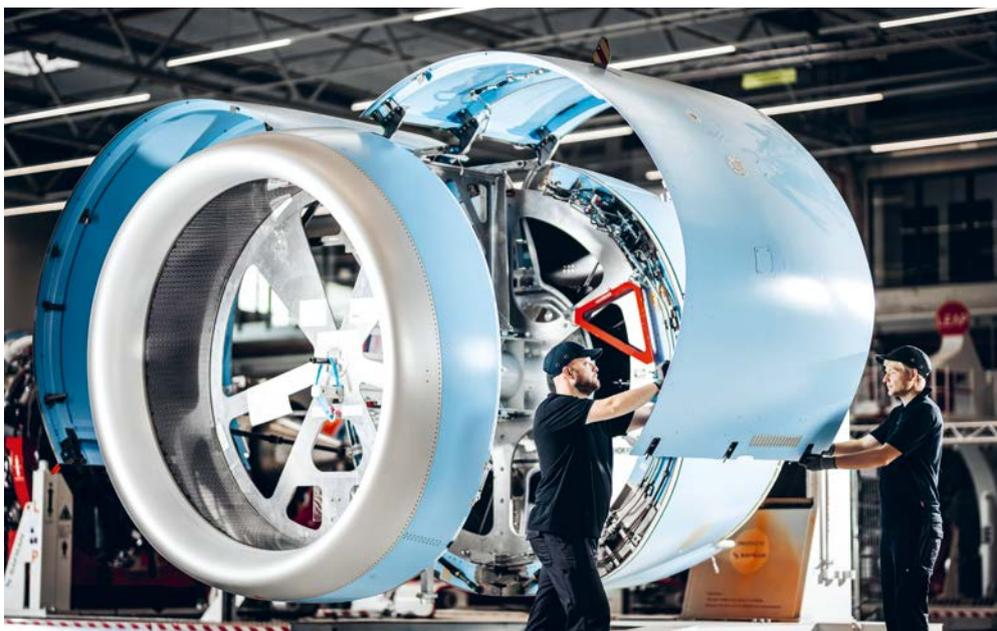
**Empleados integrando la góndola del motor LEAP-1A** que equipa el A320neo en la planta de Safran Nacelles de Hamburgo.
