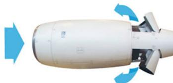
Exemple d'inverseur de poussée à portes (Target) pour l'aviation d'affaires
