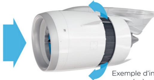
Exemple d'inverseur de poussée à grilles pour l'aviation commerciale
