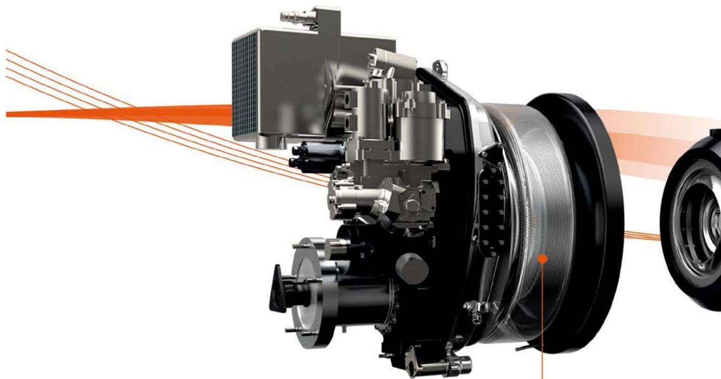
Le boîtier accessoires avec régulateur carburant comporte un réservoir d'huile intégré et un radiateur d'huile. Situé à l'avant du moteur, il permet un accès aisé et des temps de maintenance réduits.
